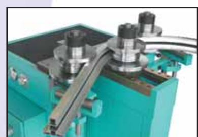
RB3-L mit Sonderwalzen für Kämpferprofil
