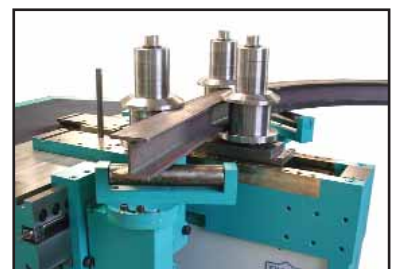
RB4 mit Stahlprofil
