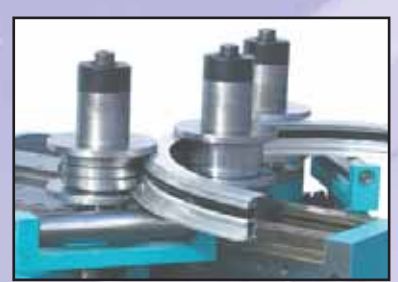
RB3 mit Sonderwalzen für Rahmenprofil
