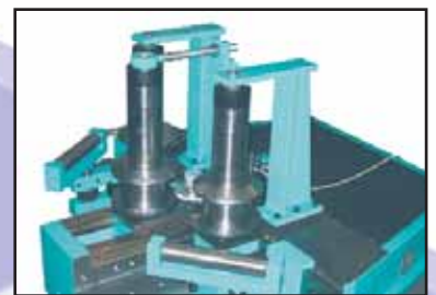
Sonderausführung mit 400mm Walzenhöhe und Wellenabstützung
