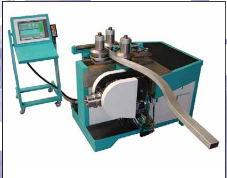
RB3 mit nach unten geschwenkter Universal-Achse (vertikale Ausrichtung)
